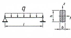
Статически определимая балка испытывает
